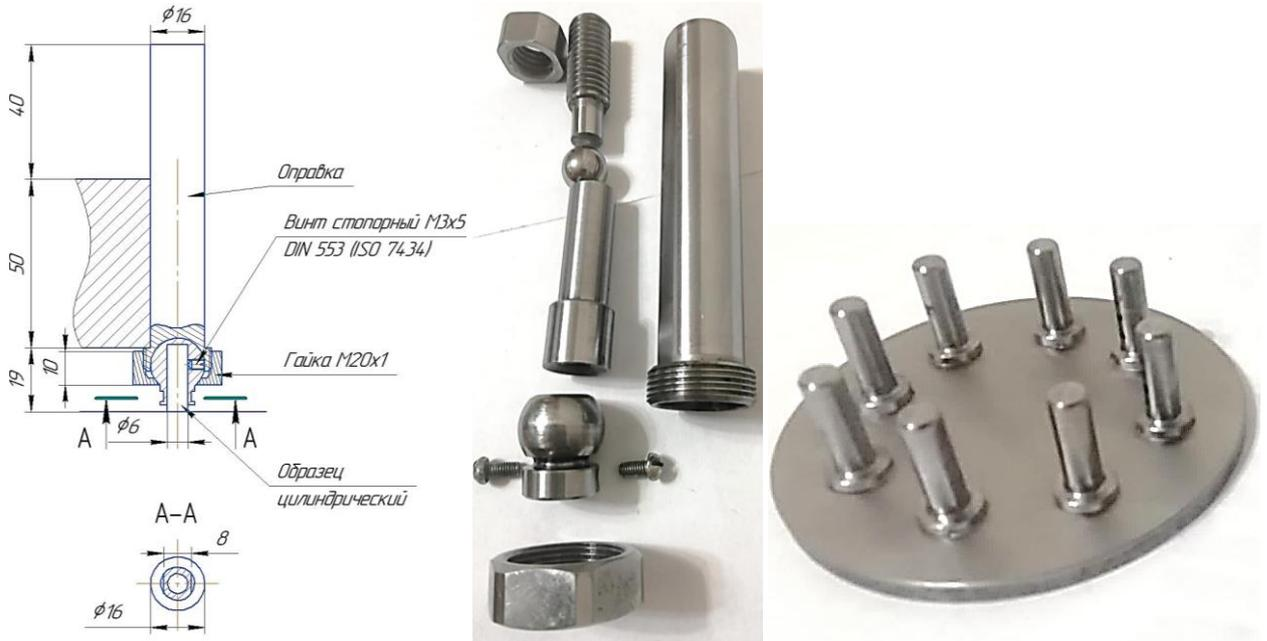
Рис. 4.23. Держатель с образцами для испытательной установки
