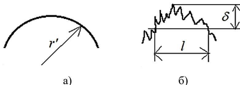
Рис. 3.24. Профили выступа: а – модель Герца; б – фрактальная модель
