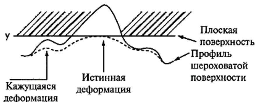
Рис. 2.1. Деформация единичной неровности
