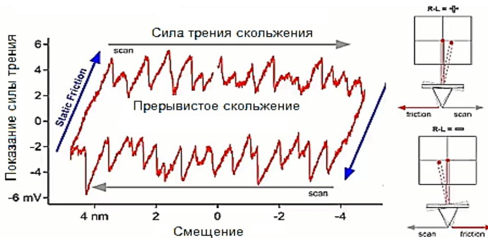
Рис. 4.13. Результат измерения силы трения
