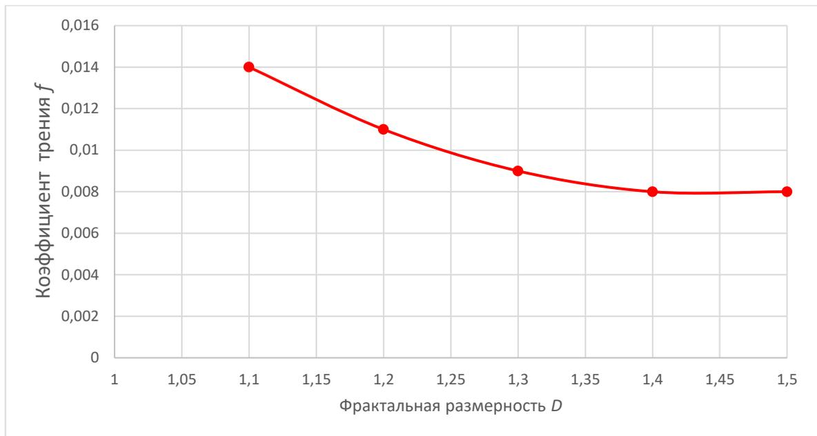
Рис. 4.4. Зависимость коэффициента трения  $f$  от размерности  $D < 1.5$
